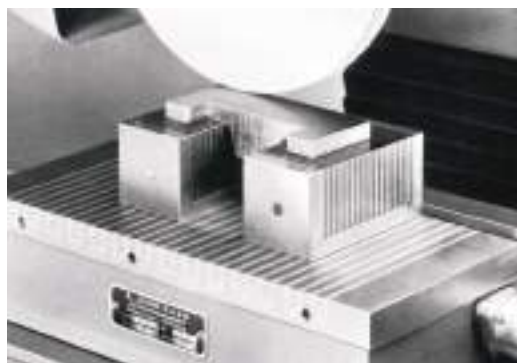
Figura 6 – Fixação com transpassadores.
